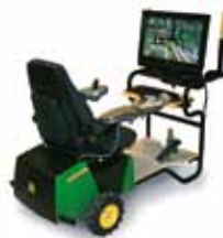
Vereinfachter Rückzugssimulator (ohne TimberMatic F-09 Steuersystem)
