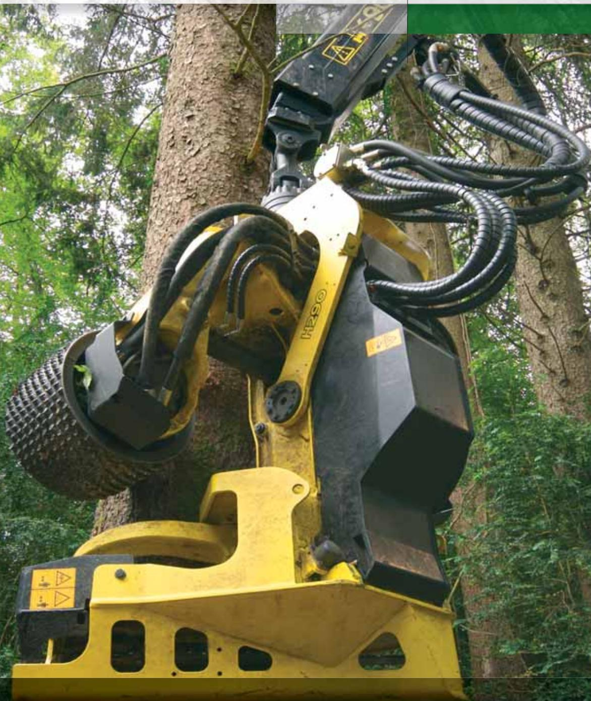
Das neue John Deere H290 ist ein starkes Hochleistungs-Aggregat der neuen Generation für Durchforstungen und Endnutzungen, das speziell für große Rad- und Raupenharvester konzipiert wurde.
